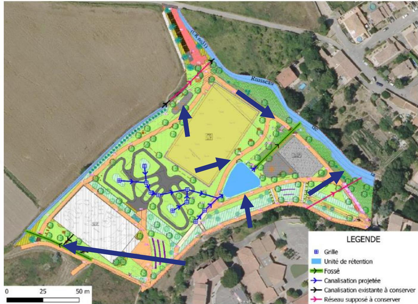
Figure 4 : Principe de gestion des eaux pluviales
